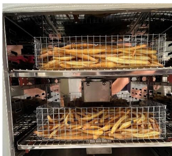
รูปที่ 2 ลักษณะการบรรจุกระชายขาวในตู้อบแห้งลมร้อนร่วมกับระบบสั่นสะเทือนอัลตราโซนิก
