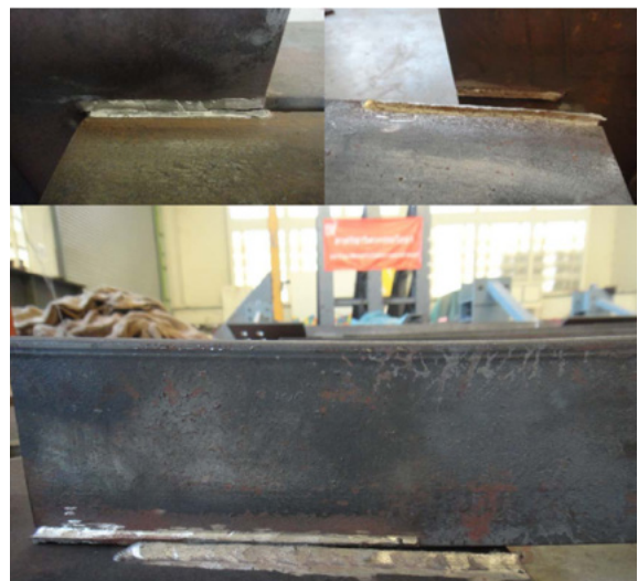
รูปที่ 6 การวิบัติแบบฉีกขาดภายใต้แรงเฉือนของรอยเชื่อม
