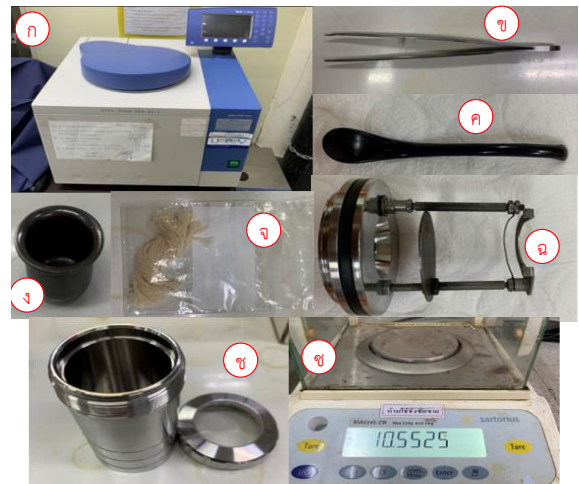
รูปที่ 3 อุปกรณ์ที่ใช้ในการทดลอง (ก) บอมบ์แคลอรีมิเตอร์ IKA C2000 (ข) แหนบสแตนเลส (ค) ช้อนตักสาร (ง) ถ้วยตวง (จ) ด้ายจุดระเบิด (ฉ) ชุดบอมบ์ (ช) ชุดถ้วยบอมบ์ และ (ซ) เครื่องชั่งดิจิตอลที่มีทศนิยม 4 ตำแหน่ง
