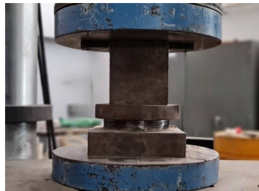
รูปที่ 1 การทดสอบกำลังรับแรงอัด
