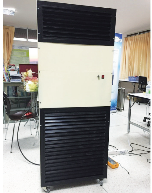
รูปที่ 5 ภาพถ่ายเครื่องบำบัดและฆ่าเชื้อโรคในอากาศภายในอาคารโดยใช้เทคนิคเชิงไฟฟ้าสถิต
