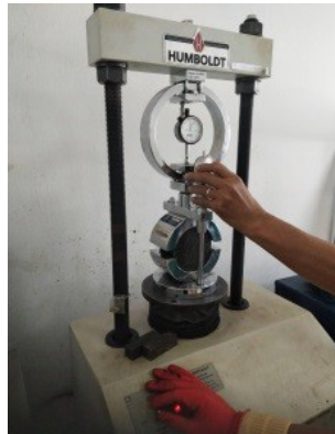
รูปที่ 4 การทดสอบแอสฟัลต์คอนกรีตโดยวิธีมาร์แชลล์
