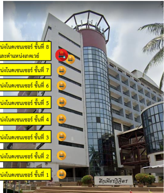
รูปที่ 6 ตำแหน่งติดตั้งโนดและเกตเวย์ที่ใช้ในการทดลอง
