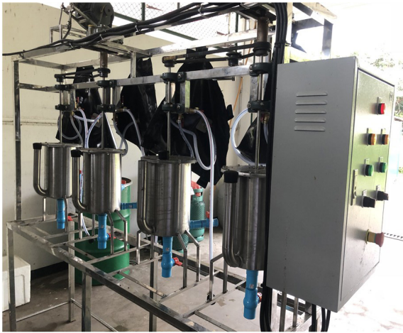
รูปที่ 1 ถังปฏิกรณ์ชนิดกวนผสมขนาด 10 ลิตร
