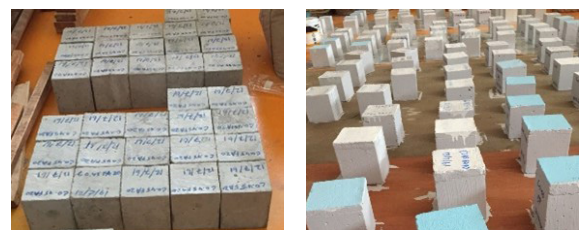
รูปที่ 4 การเตรียมตัวอย่างคอนกรีตสำหรับทดสอบการเกิดคาร์บอนเนชั่น
