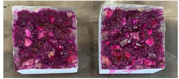
รูปที่ 2 การผ่าตัวอย่างคอนกรีตออกเป็น 2 ซีก แล้วฉีดสารละลายฟีนอล์ฟทาเลิน
