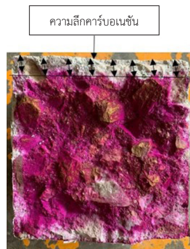
รูปที่ 3 การวัดความลึกคาร์บอนเนชั่นของตัวอย่างคอนกรีต
