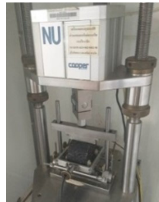
รูปที่ 5 การทดสอบค่ามอดูลัสคืนตัว
