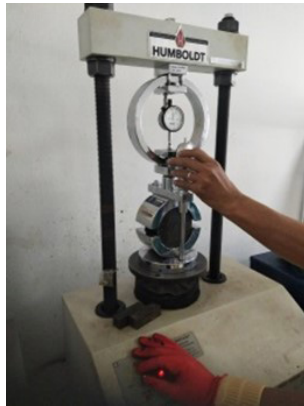
รูปที่ 3 การทดสอบแอสฟัลต์คอนกรีตโดยวิธีมาร์แชลล์
