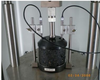
รูปที่ 6 การทดสอบความต้านทานต่อการเปลี่ยนรูปร่างอย่างถาวร
