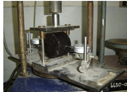
รูปที่ 4 การทดสอบความต้านทานต่อแรงดึงทางอ้อม
