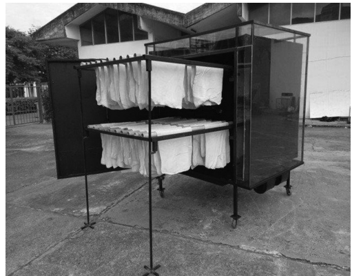
รูปที่ 1 เครื่องอบแห้งยางแผ่นพลังงานแสงอาทิตย์
