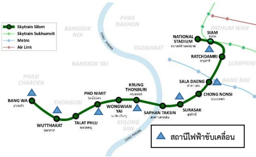
รูปที่ 4 เส้นทางวิ่งของรถไฟฟ้า BTS Skytrain สายสีลม และตำแหน่งสถานีไฟฟ้าขับเคลื่อน
