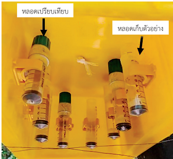
รูปที่ 2 อุปกรณ์ในการเก็บตัวอย่างไนโตรเจนไดออกไซด์ในอากาศ
