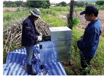
รูปที่ 2 เครื่องตัดขึ้นตาอ้อยสำหรับเตรียมวัสดุปลูก
