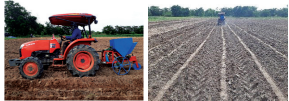
รูปที่ 5 เครื่องปลูกอ้อยฯ ที่พัฒนาขึ้นถูกลากดึงด้วยรถแทรกเตอร์ขณะทำการทดสอบ
