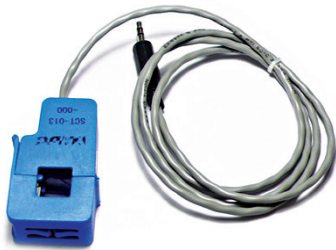
รูปที่ 3 ทหรานสดิวเซอร์กระแสที่ถูกนำมาใช้ตรวจวัดค่ากระแสไฟฟ้าในแต่ละเฟส
