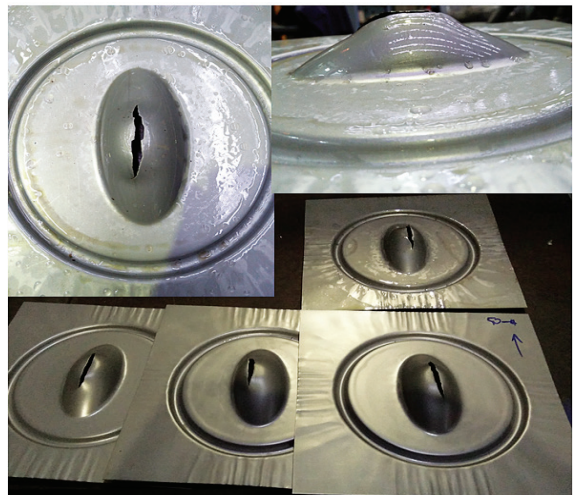
รูปที่ 9 ชิ้นงานรูปทรงวงรีที่ได้จากการขึ้นรูปแบบเป่าโป่งด้วยน้ำ
