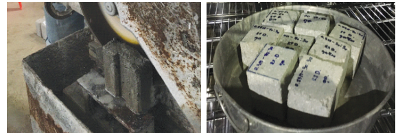
รูปที่ 2 การตัดตัวอย่างจีโอพอลิเมอร์คอนกรีตบล็อกสำหรับทดสอบกำลังอัด
