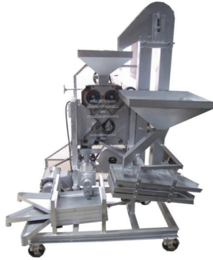
รูปที่ 3 เครื่องสีข้าวขนาดเล็กระดับชุมชนที่ได้พัฒนาขึ้น
