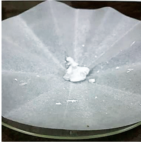
รูปที่ 2 ตะกอนสีขาวของซิลเวอร์คลอไรด์
