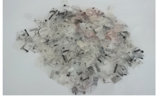
รูปที่ 1 แผงวงจรพลาสติกภายในแป้นพิมพ์คอมพิวเตอร์
