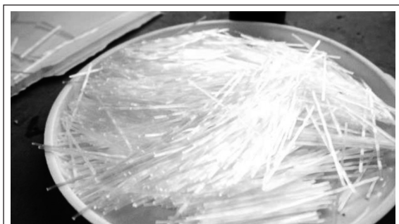
(ก) เส้นใยโพลีโพรพิลีนจากโรงงาน (ก่อนตัด)
