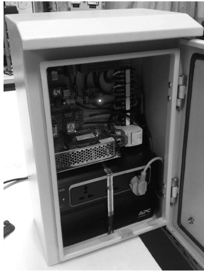
รูปที่ 3 ระบบมองกล้องฝังตัวสำหรับการเชื่อมต่อกับเซ็นเซอร์วัดอัตราการไหลและโมดูลสื่อสารไร้สาย
