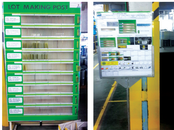
รูปที่ 7 บัตรคัมบังที่นำมาใช้ในกระบวนการประกอบ
