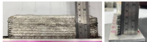
รูปที่ 5 ชิ้นงานทดสอบผนังบางที่ถูกสร้างขึ้นจากเทคโนโลยีการเติมเนื้อวัสดุแบบเติมแต่งด้วยลวดอาร์ก
