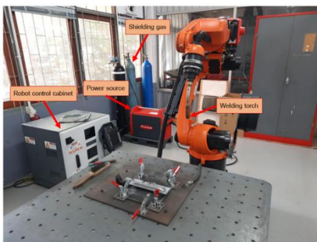
รูปที่ 3 หุ่นยนต์เชื่อมที่ใช้ในการขึ้นรูปชิ้นงานผนังบาง
