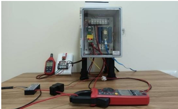
รูปที่ 6 อุปกรณ์ต้นแบบระบบเฝ้าระวังที่พัฒนาขึ้น
