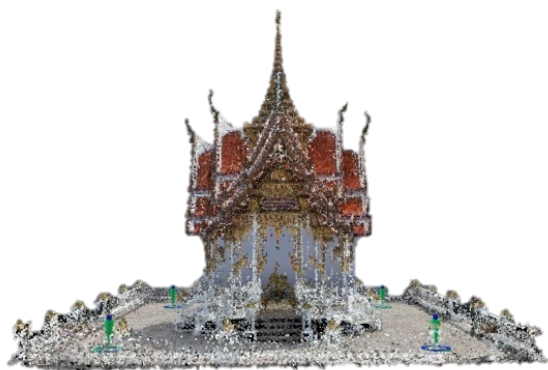
รูปที่ 6 ผลการประมวลผลภาพถ่ายจาก UAV พร้อมจุด GCP (Project A)
