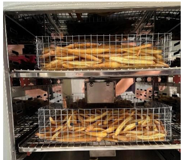
รูปที่ 2 ลักษณะการบรรจุกระชายขาวในตู้อบแห้งลมร้อนร่วมกับระบบสันสะท้อนอัลตราโซนิก
