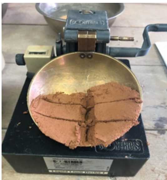
รูปที่ 5 การทดสอบหาขีดจำกัดความชื้นเหลวของดิน
