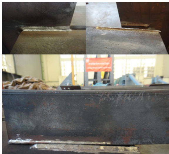
รูปที่ 6 การวิบัติแบบฉีกขาดภายใต้แรงเฉือนของรอยเชื่อม
