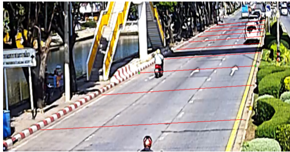
รูปที่ 2 มุมมองการติดตั้งกล้องเก็บข้อมูลและจุดอ้างอิง
