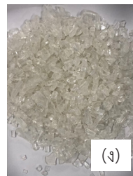
รูปที่ 2 (ก) กรอบอะลูมิเนียม ซิลิโคน และแผงเซลล์แสงอาทิตย์ (ข) แผ่นปิดด้าน (ค) แผงเซลล์แสงอาทิตย์หลังผ่านการอบแยก (ง) กระจก (จ) ทองแดง (ริบบอน) และ (ฉ) แผ่นเซลล์ซิลิกอน
