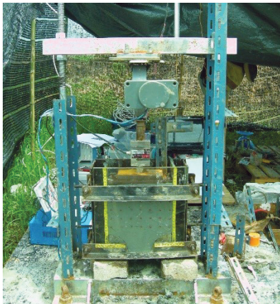
รูปที่ 6 การติดตั้งแบบจำลองเข้ากับเครื่องทดสอบในสนาม
