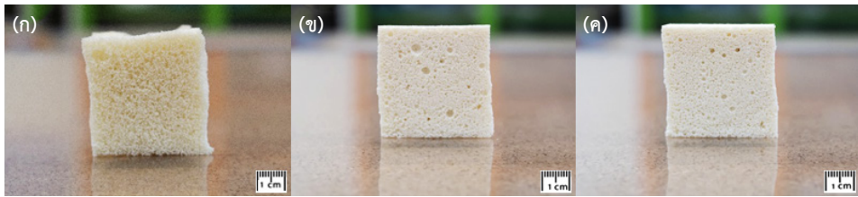
รูปที่ 2 ภาคตัดขวางทางมหภาคของโฟมยาง (ก) DF (ข) AF และ (ค) ArF
