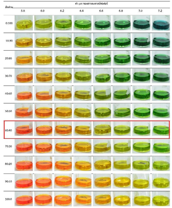
รูปที่ 2 การเปลี่ยนแปลงสีของสารละลายอินดิเคเตอร์ผสมระหว่าง Methyl Red แล Bromothymol Blue ที่อัตราส่วนต่างๆ ปริมาตร 0.30 มิลลิลิตร ในสารละลายบัฟเฟอร์ที่ค่าความเป็นกรด-ด่างในช่วง 5.8-7.2
