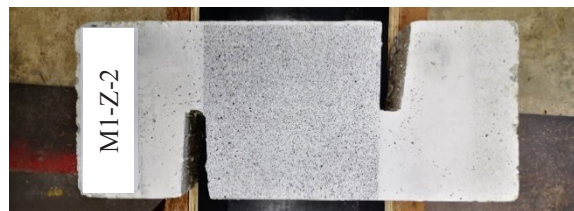
(ค) Speckle บน FOV ก่อนทำการทดสอบ รูปที่ 7 ขั้นตอนการเตรียม Speckle บนตัวอย่างทดสอบ
