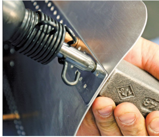
รูปที่ 2 ตัวอย่างการติดตั้งสลักย้ำอากาศยานด้านบน [12]
