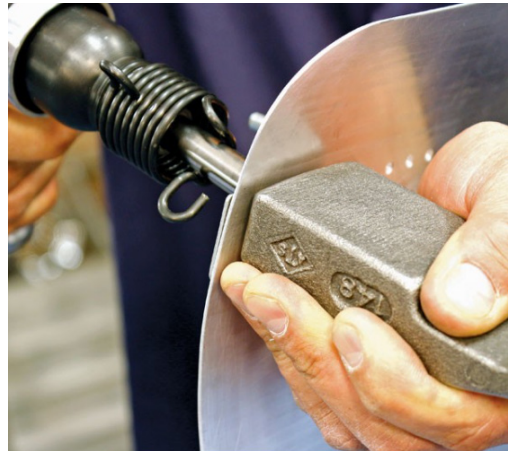
รูปที่ 3 ตัวอย่างการติดตั้งสลักย้ำอากาศยานด้านล่าง [12]
