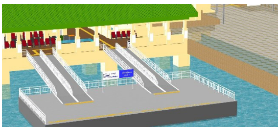
รูปที่ 18 การออกแบบพื้นผิวต่างสัมผัสใ้เสียเรือ
