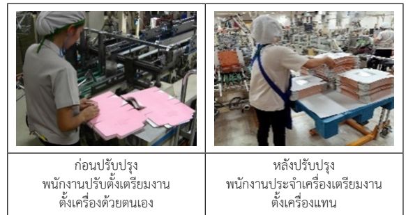
(ค) ปรับปรุงการเตรียมงานตั้งเครื่องรูปที่ 12 ภาพก่อนและหลังการปรับปรุงกิจกรรมการจัดเก็บ จัดเตรียมชุดอุปกรณ์ และการเตรียมงาน
