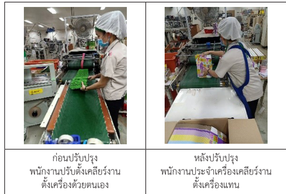
รูปที่ 13 ภาพก่อนและหลังการปรับปรุงกิจกรรมการจัดการชิ้นงานตั้งเครื่องหลังจากชุดสายพาน
