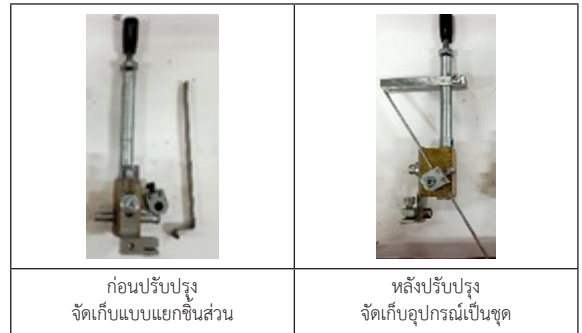
(ก) ภาพก่อนและหลังการปรับปรุงการจัดเก็บชุดตัวเกี่ยวแบบแยกชิ้น
