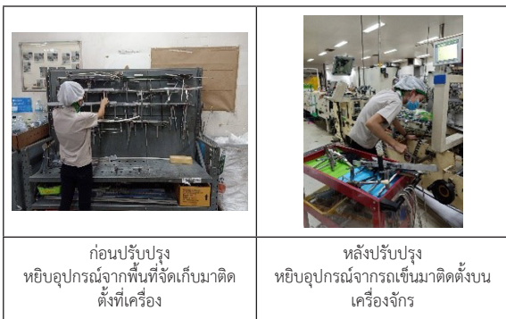
(ข) ปรับปรุงการเดินเพื่อนำอุปกรณ์ติดตั้งบนเครื่องรูปที่ 11 ภาพก่อนและหลังการปรับปรุงกิจกรรมการเดิน
