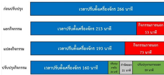
รูปที่ 15 รูปแบบเวลาการปรับตั้งเครื่องขึ้นรูปกล่องที่ลดลงโดยใช้เทคนิคการปรับเปลี่ยนเครื่องจักรอย่างรวดเร็ว
