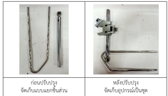
(ข) ภาพก่อนและหลังการปรับปรุงการจัดเก็บไกดัดทับชิ้นงานแบบแยกชิ้น
