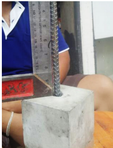
รูปที่ 2 ตรวจสอบฉากระหว่างตัวอย่างคอนกรีตกับเหล็กเส้น ข้ออ้อย
