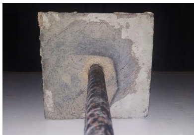
รูปที่ 3 ลักษณะตัวอย่างคอนกรีตที่มีการใช้จีโอพอลิเมอร์ มอร์ตาร์เป็นวัสดุเชื่อมประสาน
