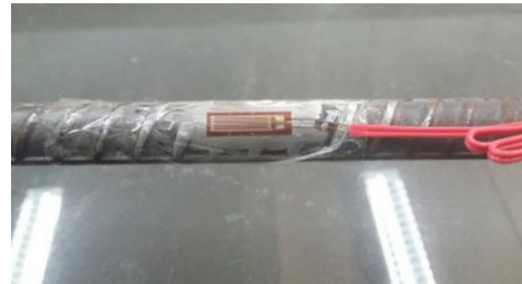
(ก) การติด Strain Gauge บนผิวเหล็กเสริม
