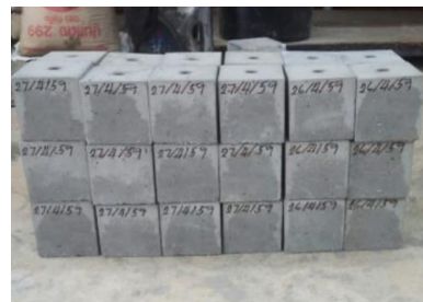
(ข) เจาะรูคอนกรีตให้มีขนาด เท่ากับ 22 มิลลิเมตร รูปที่ 1 การหล่อและเจาะรูตัวอย่างคอนกรีต
