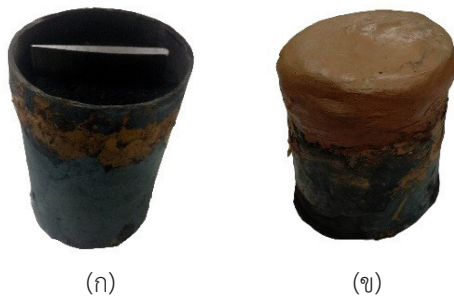
รูปที่ 4 (ก) บรรจุชิ้นทดสอบมีดลงในกล่องพร้อมสารเพิ่มคาร์บอน (ข) การปิดทับฝากล่อง
