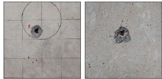
รูปที่ 6 การวิบัติ แบบ Perforation ด้านหน้า (ซ้าย) และด้านหลัง (ขวา)
