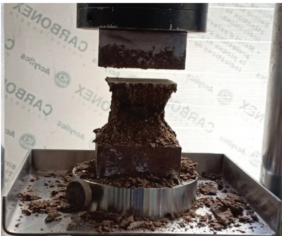
(ข) การวิบัติของ-mortar เนื่องจากกำลังอัด
