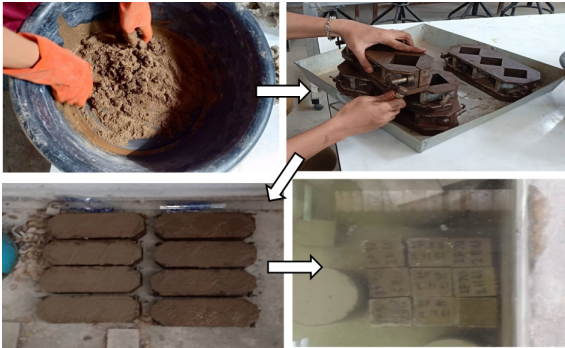
(ก) การเตรียมตัวอย่าง-mortar เพื่อทดสอบกำลังอัด
