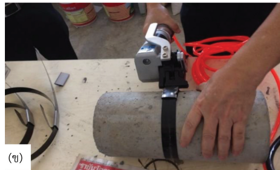
รูปที่ 1 อุปกรณ์สำหรับเสริมโครงสร้างคอนกรีต ด้วยวิธี Post-tensioned Metal Strapping (PTMS) [6]
