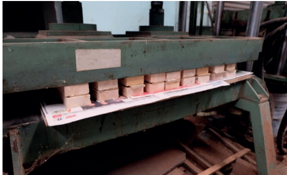
รูปที่ 4 ประกบไม้โดยวิธีอัดเย็น (Cold Press)
