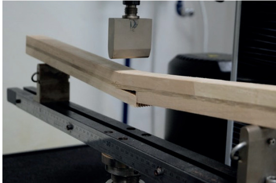
รูปที่ 10 การหักของไม้บริเวณรอยแตก ของแบบ Single Layer รหัส B-1
