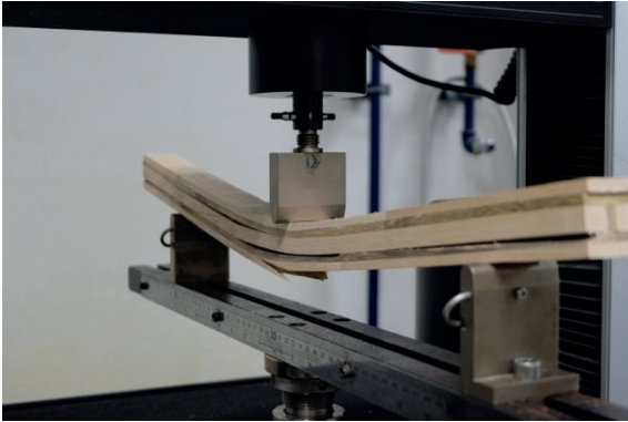
รูปที่ 14 การหักของไม้บริเวณรอยแตกของแบบ H Layer รหัส D-1
