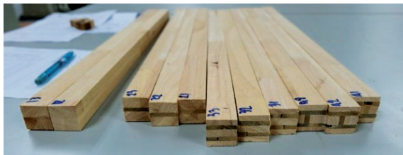
รูปที่ 5 ต้นแบบไม้ไม่และไม้ยางพาราประกบกันวางในห้องทดสอบ
