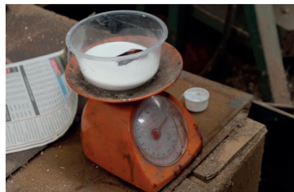
รูปที่ 3 เครื่องชั่งน้ำหนักในการผสมกาวลาเท็กซ์ และกาวเรซอซินอล ฟอรั่มัลดีไฮด์ ในอัตราส่วน 100:15
