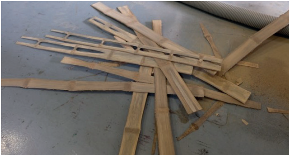
รูปที่ 1 ไม้ไผ่ที่ถูกตัดความบางให้ได้ขนาด 5 มม.
