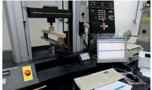
รูปที่ 6 การเตรียมเครื่องทดสอบไม้ไม่และไม้ยางพาราประกบกันในห้องทดสอบ
