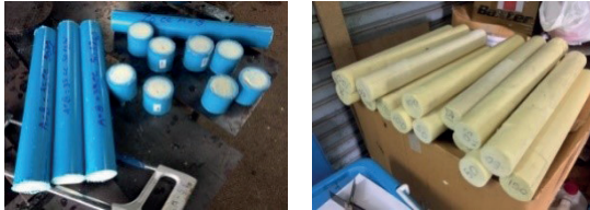
(ข) ตัดปลาย (ค) แกะโฝมออกจากแบบ รูปที่ 3 ขั้นตอนการขึ้นรูปโฝมพอลิยูรีเทน
