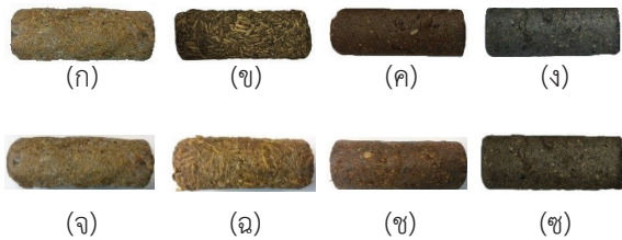
รูปที่ 3 ไขมันที่ผสมวัสดุ (ก) ไขมันผสมกลบ (ข) ไขมันผสมชুমะพร้าว (ค) ไขมันผสมกิงมะม่วง (ง) ไขมันผสมเอทานอลและโซเดียมไฮดรอกไซด์ (จ) ไขมันผสมเอทานอล โซเดียมไฮดรอกไซด์และกลบ (ฉ) ไขมันผสมเอทานอลโซเดียมไฮดรอกไซด์และชুমะพร้าว (ช) และไขมันผสมเอทานอลโซเดียมไฮดรอกไซด์และกิงมะม่วง (ช)
