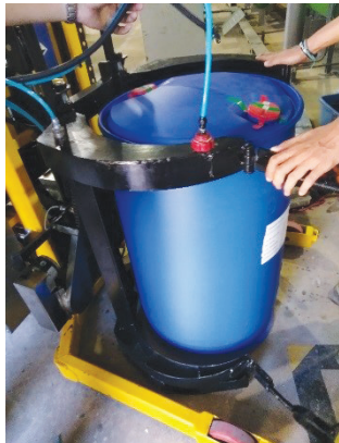
รูปที่ 15 การจับยึดถังบรรจุสารเคมีเข้ากับชุดจับยกและหมุนถัง
