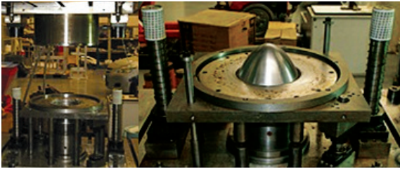
รูปที่ 21 ชุดแม่พิมพ์ที่ใช้ในการขึ้นรูปจริง [16]
