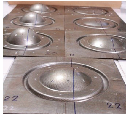
รูปที่ 3 ชิ้นงานทดสอบที่ระดับความสูงต่างๆ
