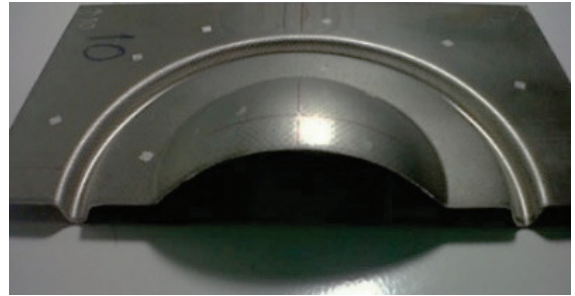
รูปที่ 11 ชิ้นงานที่ถูกตัดด้วยเครื่องตัดโลหะพลาสมา
