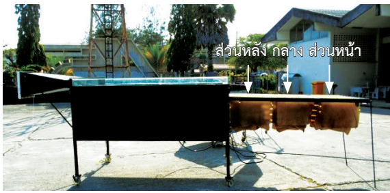
(ข) รูปจริงเครื่องอบแห้งพลังงานแสงอาทิตย์ รูปที่ 1 เครื่องอบแห้งพลังงานแสงอาทิตย์
