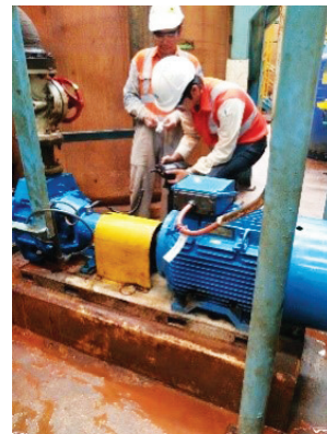
รูปที่ 6 การปฏิบัติงานขณะวัดค่าความสั่นสะเทือน
