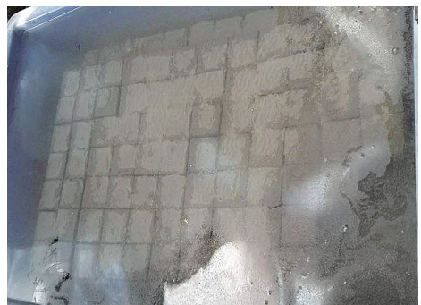
(ค) บ่มตัวอย่างคอนกรีตในน้ำ
