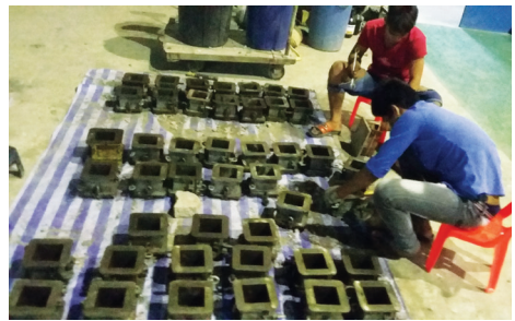
(ก) ผสมเถ้านหินกับ NaOH ที่ทิ้งไว้เป็นเวลา 10 นาที
