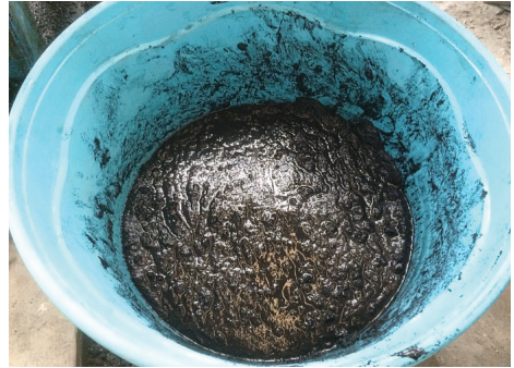
(ก) ผสมเถ้านหินกับ NaOH ที่ทิ้งไว้เป็นเวลา 10 นาที
